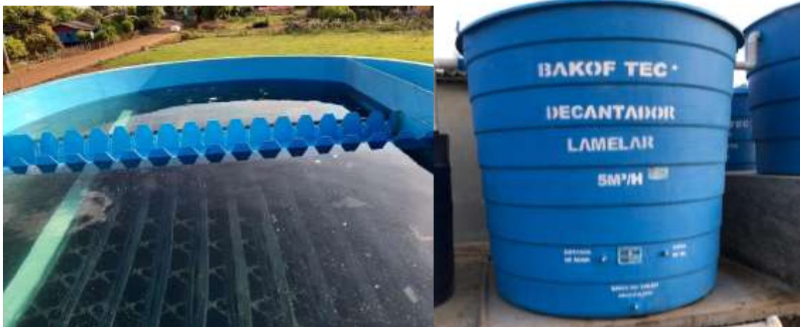
Figura 05 – Tanque de Decantação Bakof Tec.
